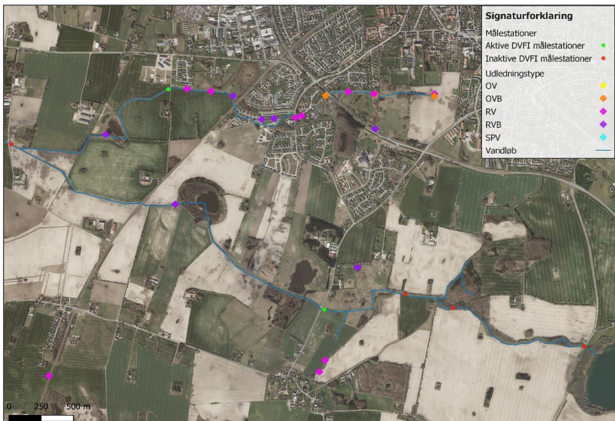
Figur 25. Tilløb til Suså syd for Haslev med målestationer og angivelse af forskellige tilløbstyper (OV=overløb, OVB=overløb m. bassin, RV=regnvand, RVB=regnvand m. bassin, SPV=reanseanlægssudløb).
