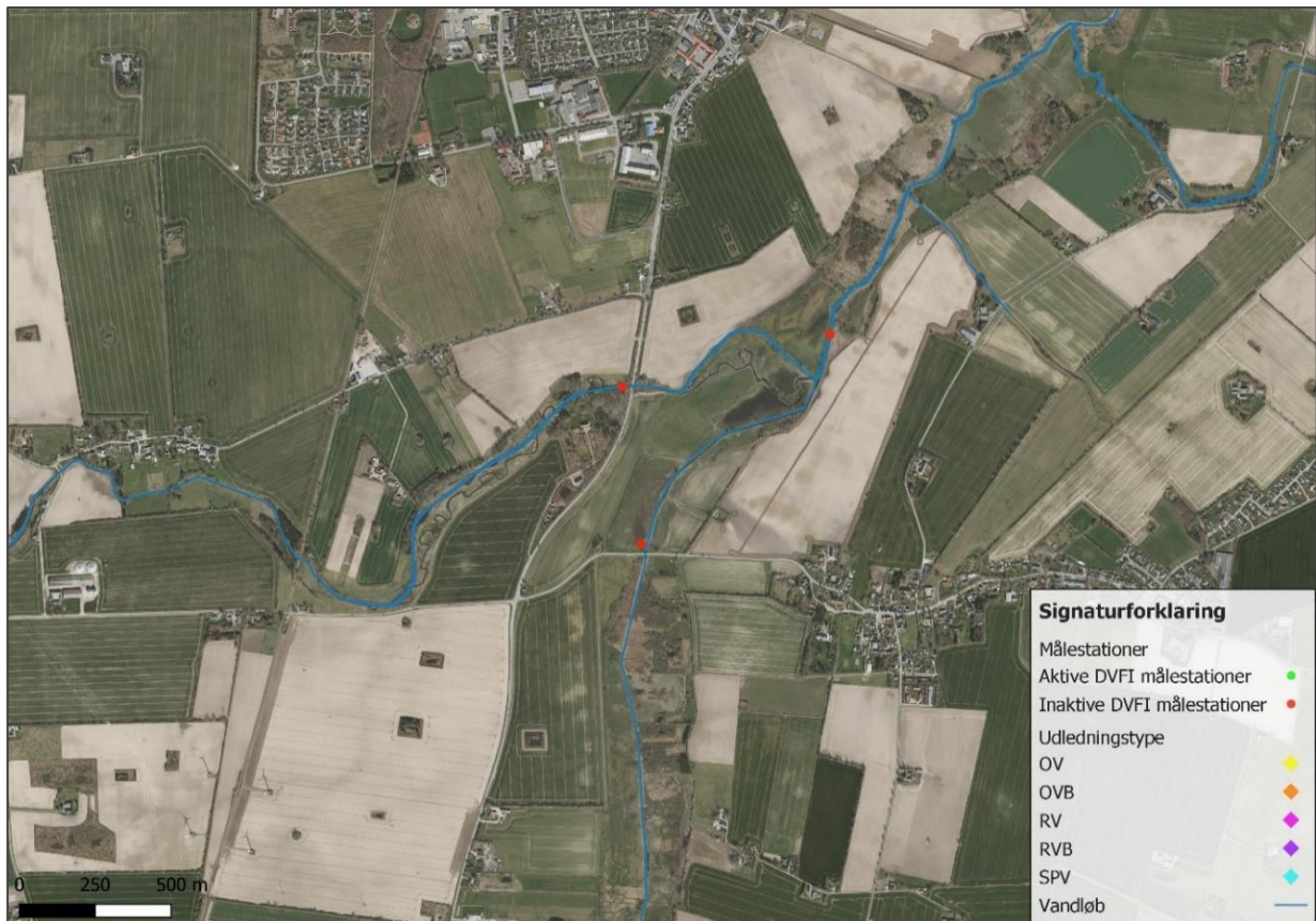
Figur 11. Tryggevælde Å og Stevns Å med målestationer og angivelse af forskellige tilløbtyper (OV=overløb, OVB=overløb m. bassin, RV=regnvand, RVB=regnvand m. bassin, SPV=reanseanlægssudløb).
